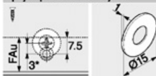
FAu Otvaranje fronta nadole * 3 mm pomerenja montaža
